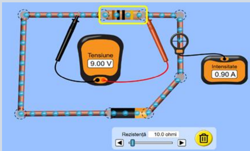
CIRCUIT ELECTRIC UTILIZAT PENTRU STUDIUL LEGII LUI OHM
